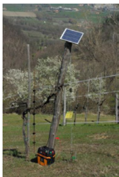
Рис. 19. Электрический забор с солнечной батареей в Италии для защиты виноградников от повреждения дикими кабанями.
